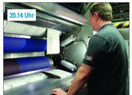
Aufspannen der Druckplatten.
