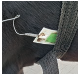
Gel und Wasser sorgen für guten Kontakt der Elektroden.
