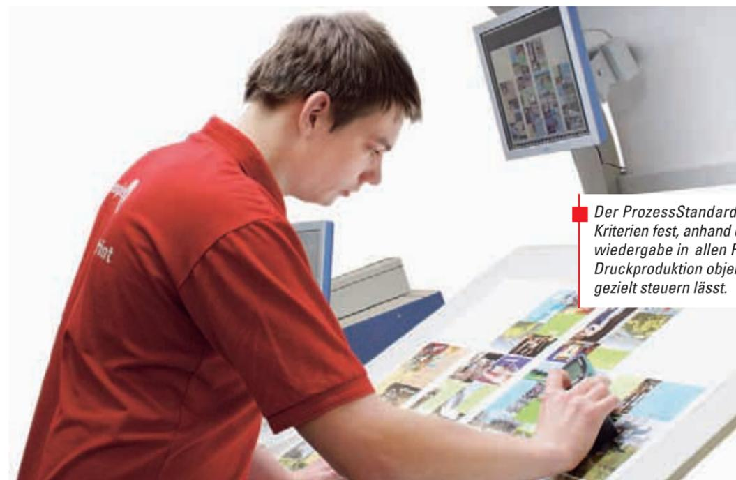
Der ProzessStandard Offsetdruck legt Kriterien fest, anhand derer sich die Farbwiedergabe in allen Prozessstufen der Druckproduktion objektiv beurteilen und gezielt steuern lässt.
